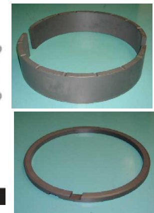
高圧水素インフラに用いる樹脂シール材の摩耗評価
