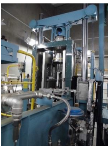
圧力~140MPaの高圧水素ガス中の各種強度試験
